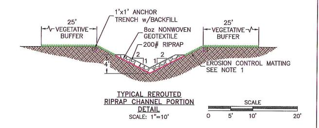
NATURAL SOIL 200# RIPRAP ANCHOR TRENCH BACKFILL 8oz NONWOVEN GEOTEXTILE EROSION CONTROL MATTING VEGETATION
